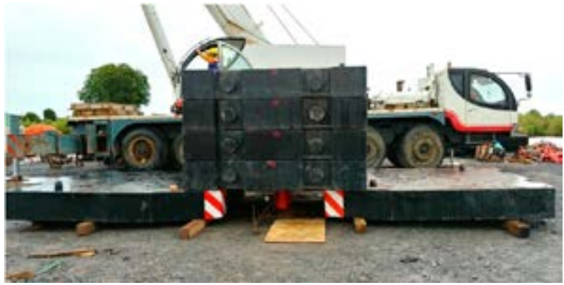
Hình 2. Thí nghiệm đo mô đun đàn hồi mặt bãi cầu chính – trụ 7
