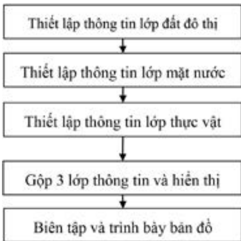
Hình 7. Quy trình biên tập bản đồ bằng phần mềm ArcGIS
