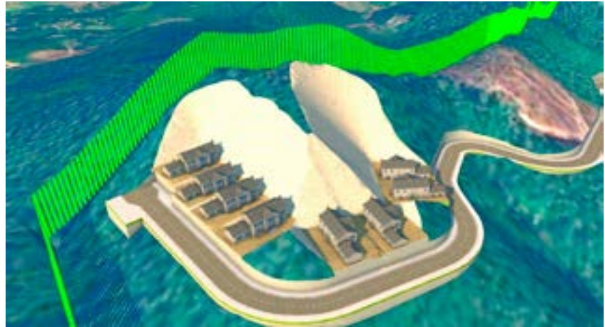
Hình 7. Mô phỏng giải pháp đào má tta luy từ chân lên đến đỉnh và trồng cỏ giữa má
