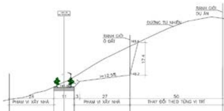
Hình 6. Mặt cắt ngang khối lượng đào đắp
