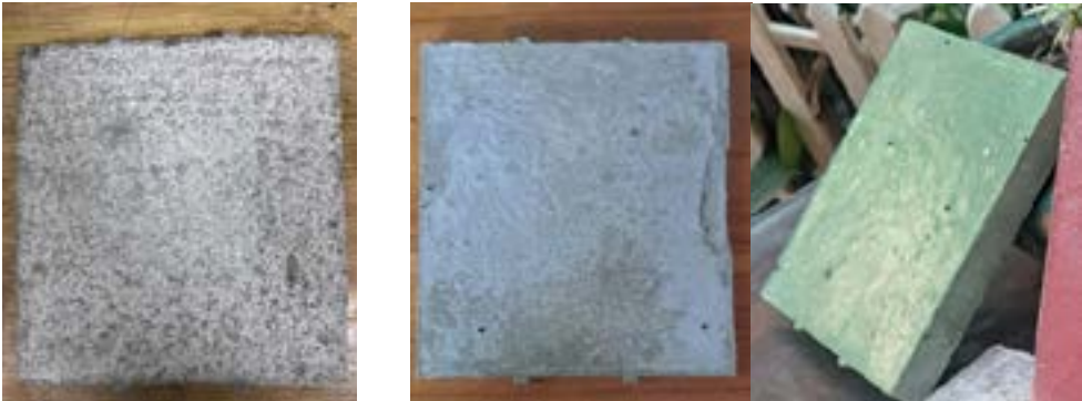
Hình 7. (a) Mẫu tấm ốp kiểm chứng; (b) Mẫu tấm ốp từ vỏ hào
