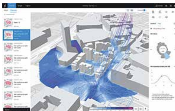
Hình 6. Phân tích khí động học bằng phần mềm Spacemaker
