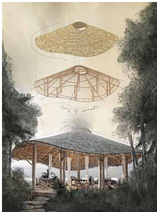
Hình 6. Lớp mái trong cấu tạo công trình mái tranh là yêu cầu bảo dưỡng cao. Sau 3-7 năm cần thay mái một lần. Độ bền của mái còn phụ thuộc vào chất lượng loại rơm, lá, cỏ tranh thu hoạch, độ ẩm và chất hữu cơ tích tụ sau mưa, cây che phủ,...
