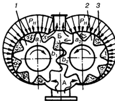
Hình 3.6. Sơ đồ bơm bánh răng ăn khớp ngoài
