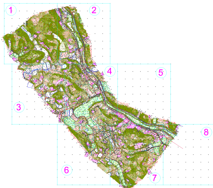
Hình 8: Bản đồ địa hình khu vực nghiên cứu được thành lập từ dữ liệu bay chụp UAV
