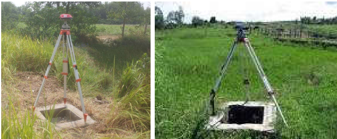
Hình 4: Máy GPS đặt tại điểm gốc và đặt tại điểm nhà máy
