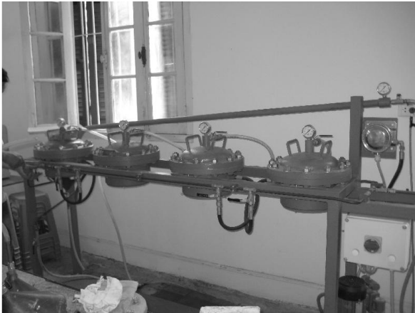
Hình 2- Máy thí nghiệm xác định hệ số thấm với 4 khoang chứa mẫu của Matest
