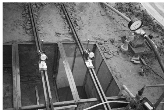
Ảnh 1. Thí nghiệm xói ngầm, cát chảy bằng phương pháp ép nước vào giếng khoan
