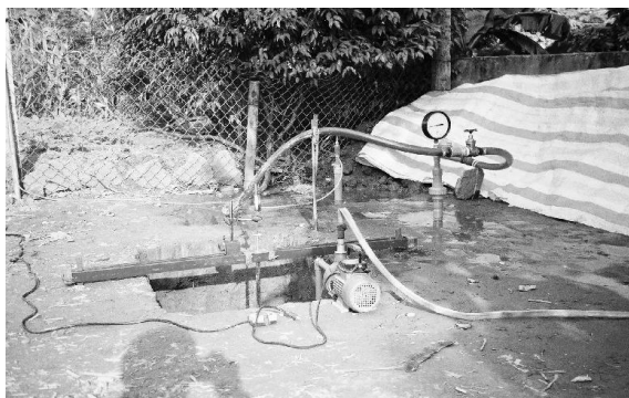
Ảnh 1. Thí nghiệm xói ngầm, cát chảy bằng phương pháp ép nước vào giếng khoan
