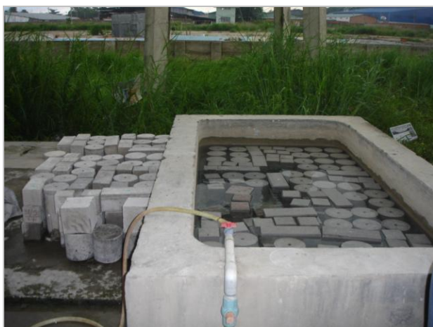
Hình 1. Gia công mẫu bê tông thí nghiệm
