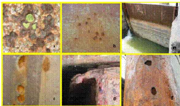
Hình 2. Các hình thức ăn mòn vật liệu thép cửa van: a) Ăn mòn không đều; b), c) Ăn mòn lỗ; d) Ăn mòn khe; e) Ăn mòn vùng triều; f) Ăn mòn mài mòn
