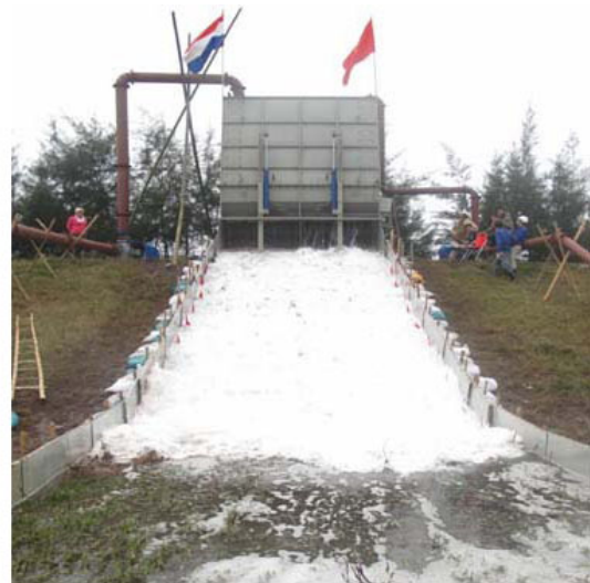
Hình 3. Máy xả sóng: trái, nguyên lý hoạt động và phải, vận hành xả sóng trên mái đê thực tế
