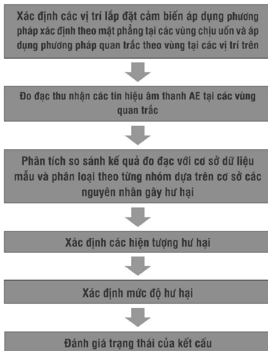
Hình 7. Quy trình triển khai đo đạc và quan trắc bằng phương pháp sóng âm thanh IADP
