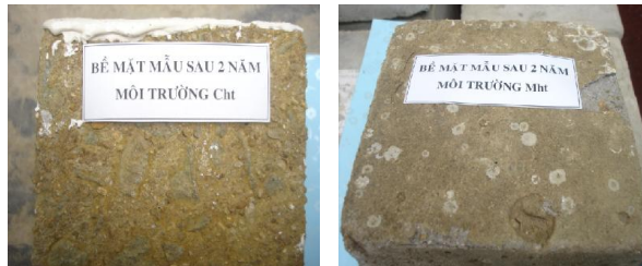
Hình 6. Hình ảnh bề mặt mẫu bê tông ngâm trong các môi trường Cht và Mht
