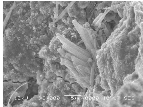
Hình 5. Cấu trúc đá xi măng độ phóng đại 6000 lần- Cấp phối A- Môi trường Mht - Tuổi hơn 9 tháng
