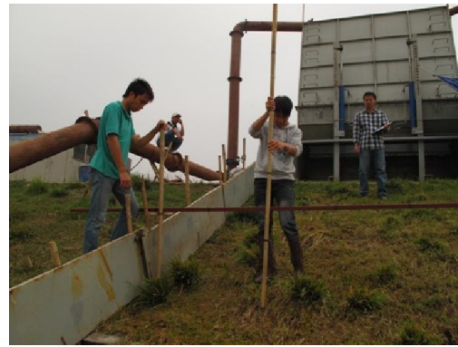
Hình 2. Đo mặt cắt mái đê.
