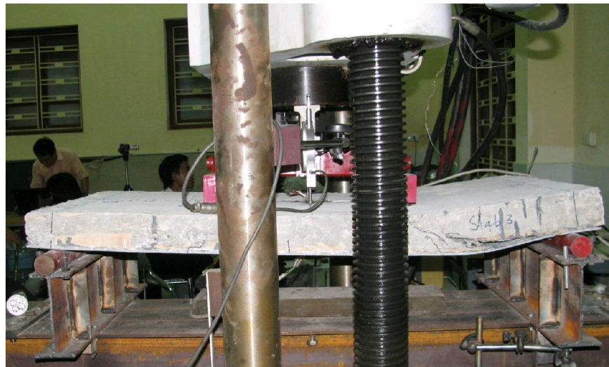
Hình 3: Hình ảnh kết quả thí nghiệm của bản ở trạng thái phá hoại
