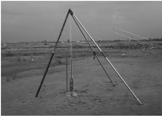
Hình 9: Thí nghiệm xuyên tại độ sâu -0.9m
