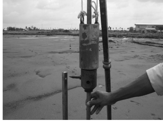
Hình 8: Mũi xuyên cắm vào đất nền 2cm
