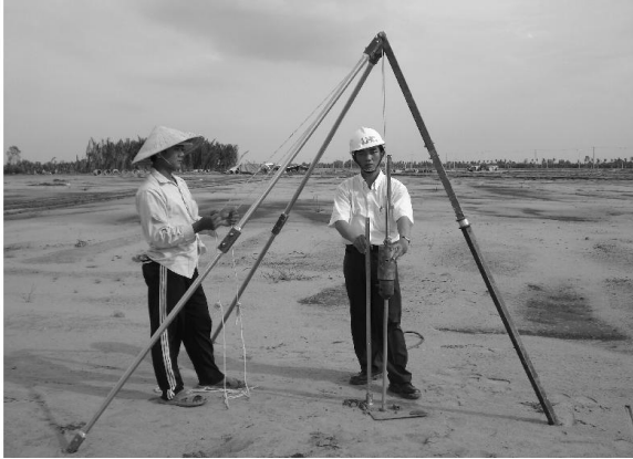
Hình 7: Thực hiện thí nghiệm xuyên động
