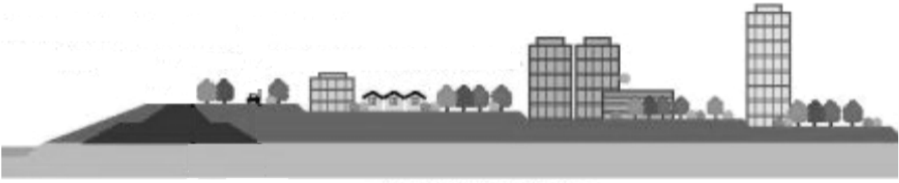
Hình 3. Dạng mặt cắt ngang của đê an toàn cao, thân thiện với môi trường
