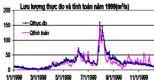
Hình 6. Biểu đồ kiểm định dòng chảy thực đo và tính toán mô hình Tank năm 1999 và 2001
