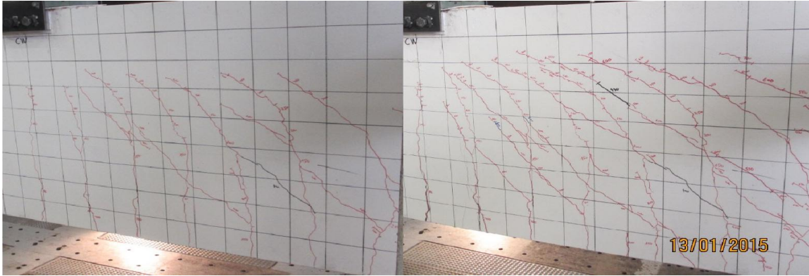
Hình 16. CW-Pha 2 và pha 3: Các vết nứt chéo xuất hiện do uốn và cắt
