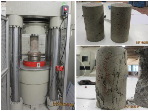
Hình 7. Thí nghiệm nén mẫu bê tông
