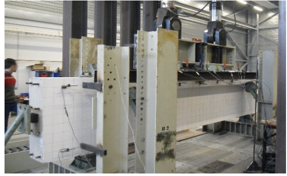
Hình 1. Sơ đồ chịu lực của dầm BTCT.
