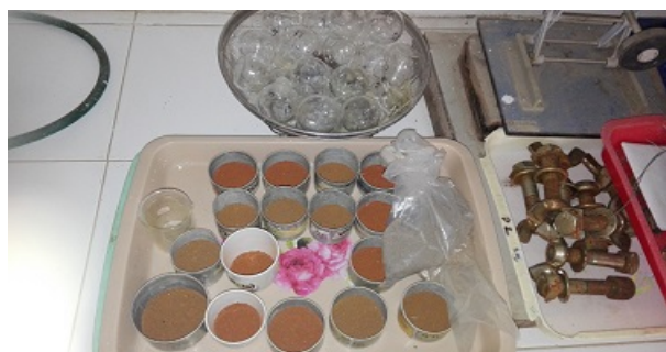
Hình 5. Thí nghiệm xác định áp lực hút nước của đất
