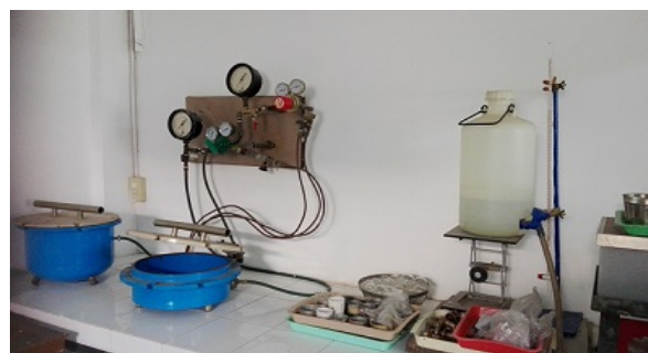
Hình 5. Thí nghiệm xác định áp lực hút nước của đất
