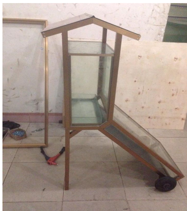
Hình 6. Phiên bản máy sấy nông sản dùng năng lượng Mặt trời, khối lượng nông sản tối đa là 10 kg (diện tích tấm hấp thụ năng lượng là 1,47 m 2 )
