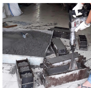
Hình 2. Đúc mẫu BTĐLCLXT bằng khuôn đúc và búa rung
