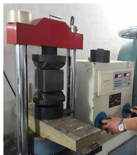
Hình 6. Thí nghiệm cường độ ép chẻ
