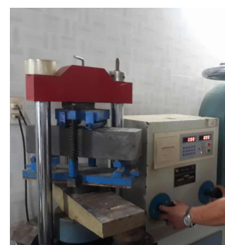
Hình 5. Thí nghiệm cường độ chịu uốn
