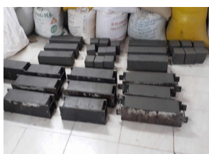
Hình 3. Mẫu BTĐLCLXT sau khi đúc
