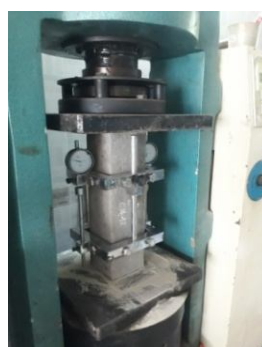
Hình 4. Thí nghiệm cường độ chịu nén
