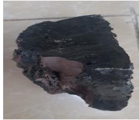
Hình 10. Dạng kết tủa của xỉ trước hiệu chỉnh
