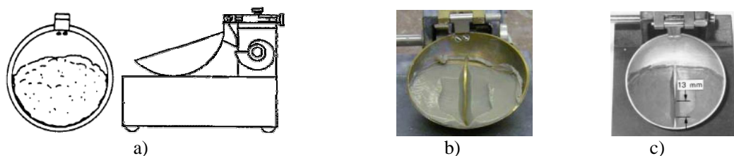
Hình 1: Dụng cụ Casagrande để xác định giới hạn chảy của đất
