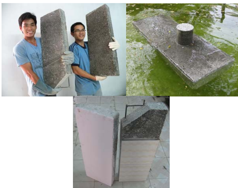
Hình 9. Panel tường và panel sàn làm từ cấp phối bê tông nhẹ EPS QH 7 và QH6, trước và sau công tác hoàn thiện (bả bột và lăn sơn đối với panel tường, lát gạch nền cho panel sàn)
