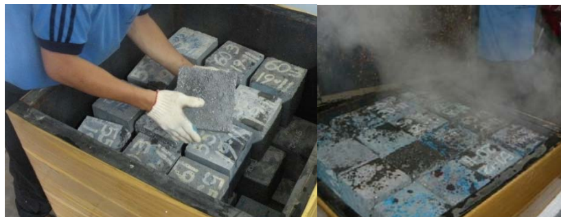
Hình 4. Dưỡng hộ nhiệt ẩm bê tông EPS ở 80°C trong 48 giờ
