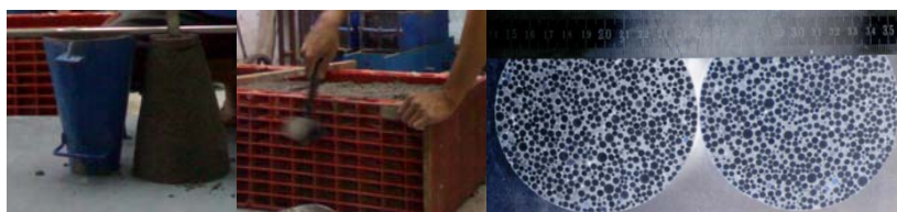
Hình 8. Chế tạo panel tường theo cấp phối bê tông nhẹ EPS QH 7, khối lượng thể tích là 872 \text{ kg/m}^3 , độ sụt là 0 cm và cường độ nén 5.8 MPa, các hạt EPS phân bố rất đều trong cấu trúc.
