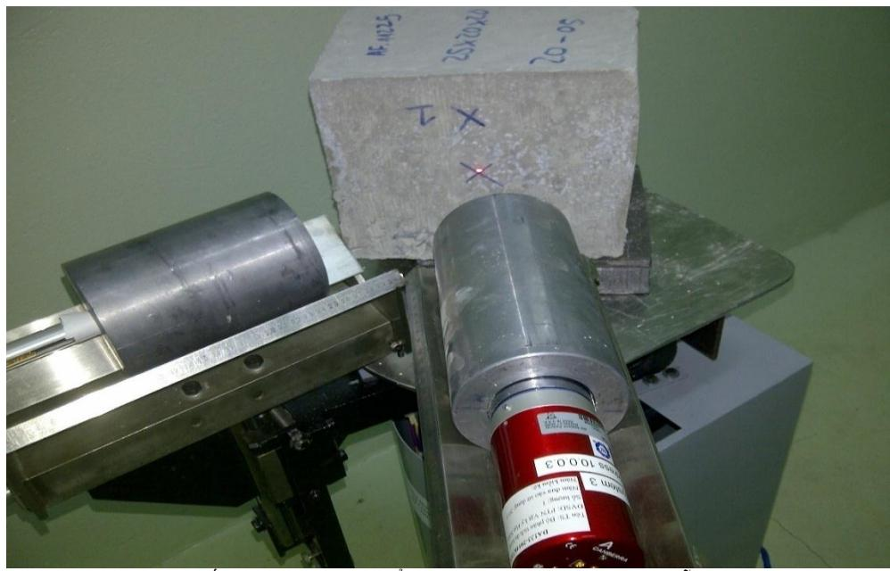
**Hình 1.** Bố trí thí nghiệm đo phô tán xạ ngược gamma cho các mẫu bê tông
