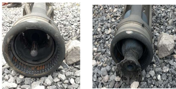
Hình 3. Hư hỏng tại buồng cắt pha B
