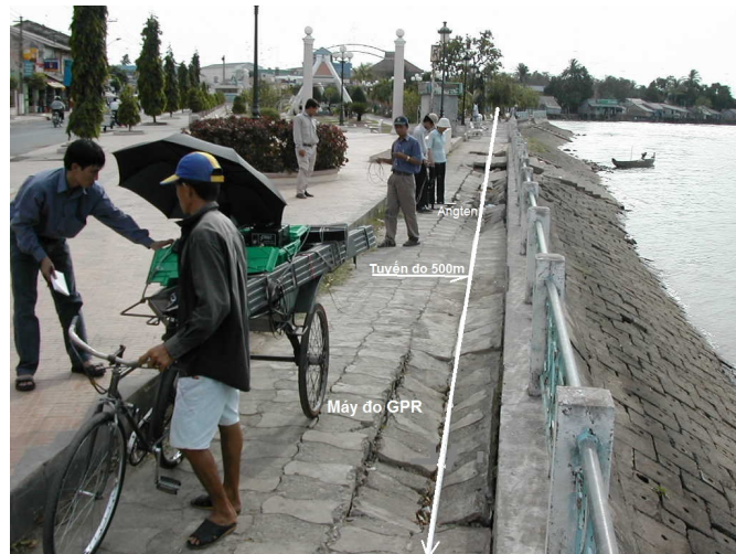
Hình 2. Sơ đồ ghép nối của thiết bị Pulse EKKO 100A và vị trí tuyến đo từ điểm đầu của kè Vĩnh Long đến Khách sạn Cửu Long dài 500m
