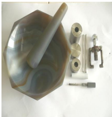
Hình 1a. Các dụng cụ để chế tạo điện cực
