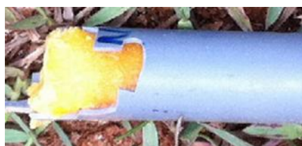
Hình 3.1. Liều thuốc nổ PBX còn lại sau khi kích nổ (lan truyền nổ bị tắt).
