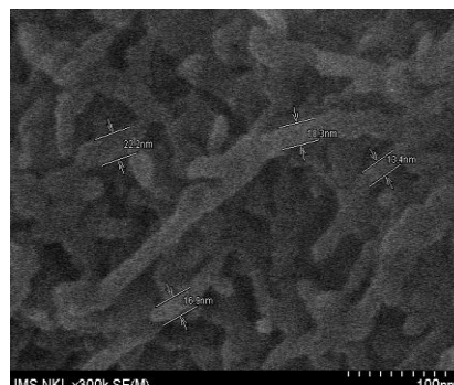
Hình 2b. Bề mặt hỗn hợp CNTs và OPyPF 6
