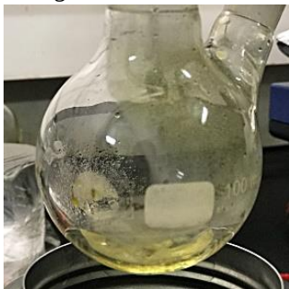
Hình 2. Tinh thể không kết tinh trong điều kiện đặt giảm dần nhiệt độ từ nhiệt độ phản ứng về nhiệt độ phòng (phần dung dịch I)
