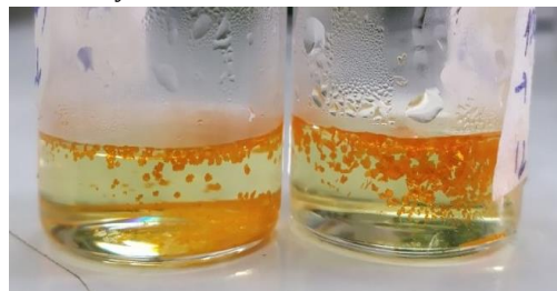
Hình 3. Tinh thể kết tinh khi có gradien nhiệt độ (phần dung dịch II)
