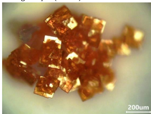
Hình 4. Hình thái và kích thước tương đối của tinh thể DANPI qua kính hiển vi
