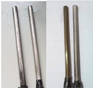
Hình 2. Ảnh điện cực trước và sau khi điện phân
