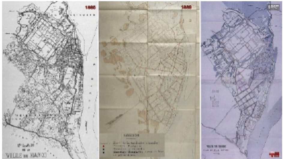
Bản đồ hiện trạng Hà Nội năm 1885 có diện tích 14km 2 với khu phố cổ xen lẫn làng xóm hồ ao và thành lũy. Bản sơ đồ thiết kế năm 1889, mạng lưới cấp nước, vị trí các trụ nước cứu hỏa. Bản sơ đồ quy hoạch năm 1884 có 4 đường phố lớn tạo thành ô bàn cờ phía Nam Hồ Hoàn Kiếm
