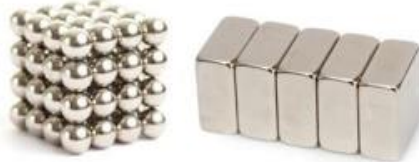
Hình 2. Minh họa nam châm đất hiếm dạng cầu và dạng khối
