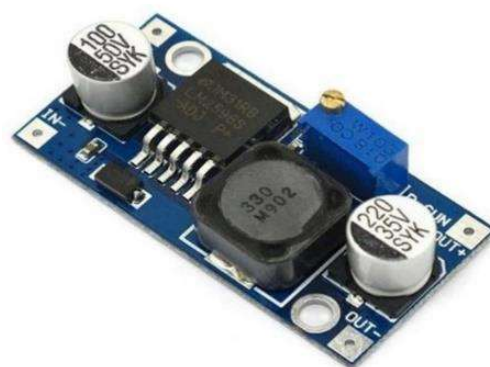
Hình 10. Mạch hạ áp LM2596
