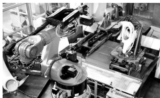
Hình 4. Robot Kuka ứng dụng trong sơn sản phẩm và lắp ráp ô tô [5]
