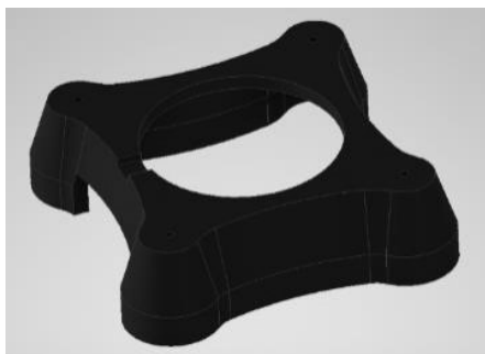
Hình 8. Đế robot được thiết kế bằng phần mềm Inventor
