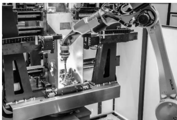
Hình 3. Robot bốc xếp sản phẩm[4] và robot hàn Kuka [5]
