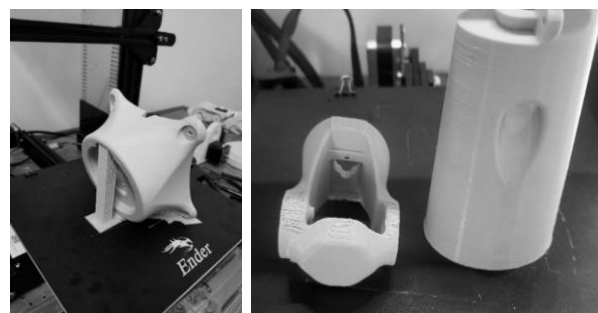
Hình 18. Chế tạo các khâu của robot bằng công nghệ in 3D
