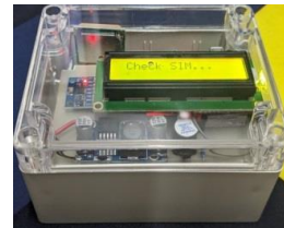
Hình 6. Thiết bị IoT cảnh báo tai nạn và quản lý hành trình ô tô
