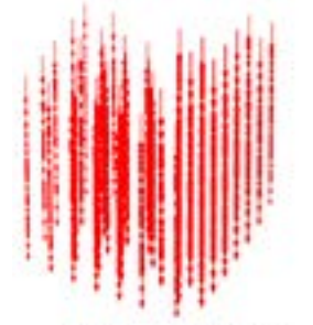
Hình 11. Mô hình 3D hệ đài cọc và hang Các tơ phương án 2
