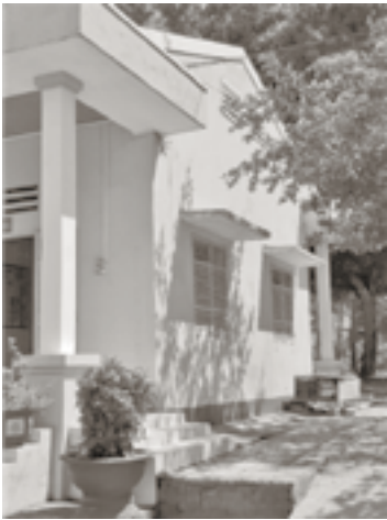
Hình 5. Giải pháp thông gió cửa trước sau và che nắng đầu hồi nhà ở chiến sĩ tại Kiên Giang
