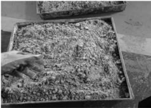
Hình 2. Thạch cao FGD trước và sau sấy
