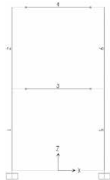
Hình 6. Sơ đồ tính toán khung có liên kết khớp trong phần mềm Sap2000
