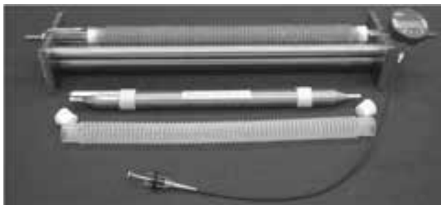
Hình 4. Thiết bị thí nghiệm co tự sinh theo ASTM C1698
