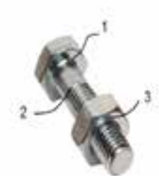
Hình 1: Các vị trí xảy ra phá hoại mỏi của bu lông:
