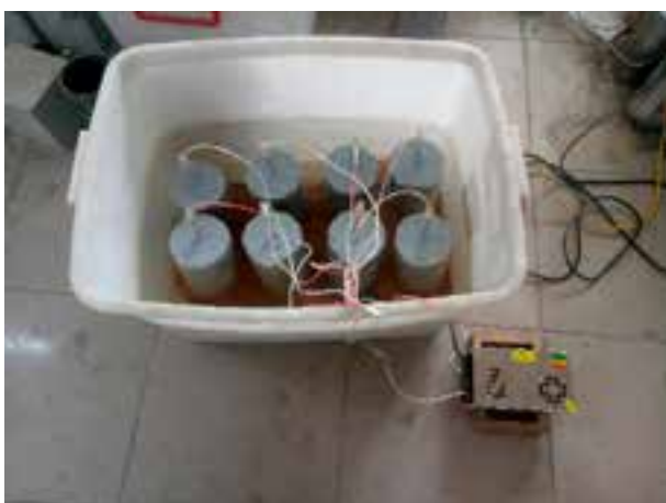
Hình 3. Thử nghiệm khả năng bảo vệ cốt thép của bê tông
