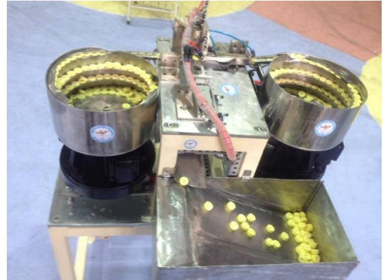
Hình 12. Máy tự động dán kẹo sáo
